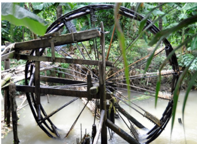
ภาพที่ ๑ ระหัดวิดน้ำแบบใช้พลังงานน้ำโดยตรง ที่มา : สีสันโคราช, ๒๐๑๗.
